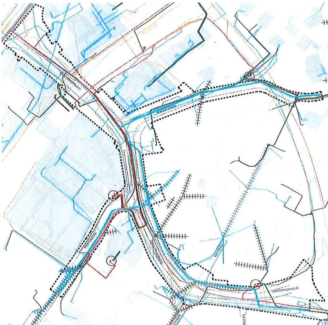
Figur 5: Eksisterende og planlagte kabler
